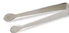
Lorsque la force est augmentée, le déplacement est diminué et réciproquement. En effet, un levier est une machine simple qui conserve l'énergie. Il donne autant de travail à la sortie qu'il en reçoit à l'entrée, donc le produit de la force par le déplacement est le même à l'entrée et à la sortie.
