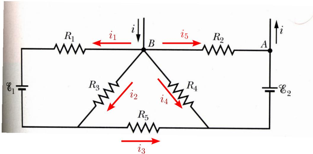
$$\begin{aligned} i &= i_1 + i_2 + i_4 + i_5 \\ e_1 + R_1 i_1 - R_3 i_2 &= 0 \\ e_2 + R_2 i_5 - R_4 i_4 &= 0 \\ R_3 i_2 + R_5 i_3 - R_4 i_4 &= 0 \\ i &= i_5 + i_3 + i_4 \\ 0 &= i_1 + i_2 - i_3 \end{aligned}$$
