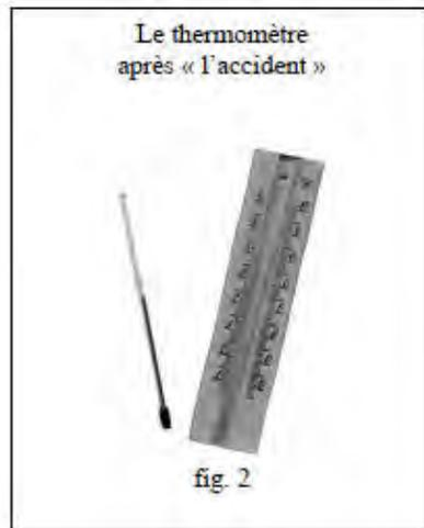
**Margaux joue dans la maison familiale avec l'unique thermomètre. Celui-ci est constitué d'un tube avec un réservoir contenant un liquide coloré qui est collé dans la rainure d'un support en bois portant la graduation en degrés Celsius. Par accident, le tube contenant le liquide coloré se décolle du support en bois.**
